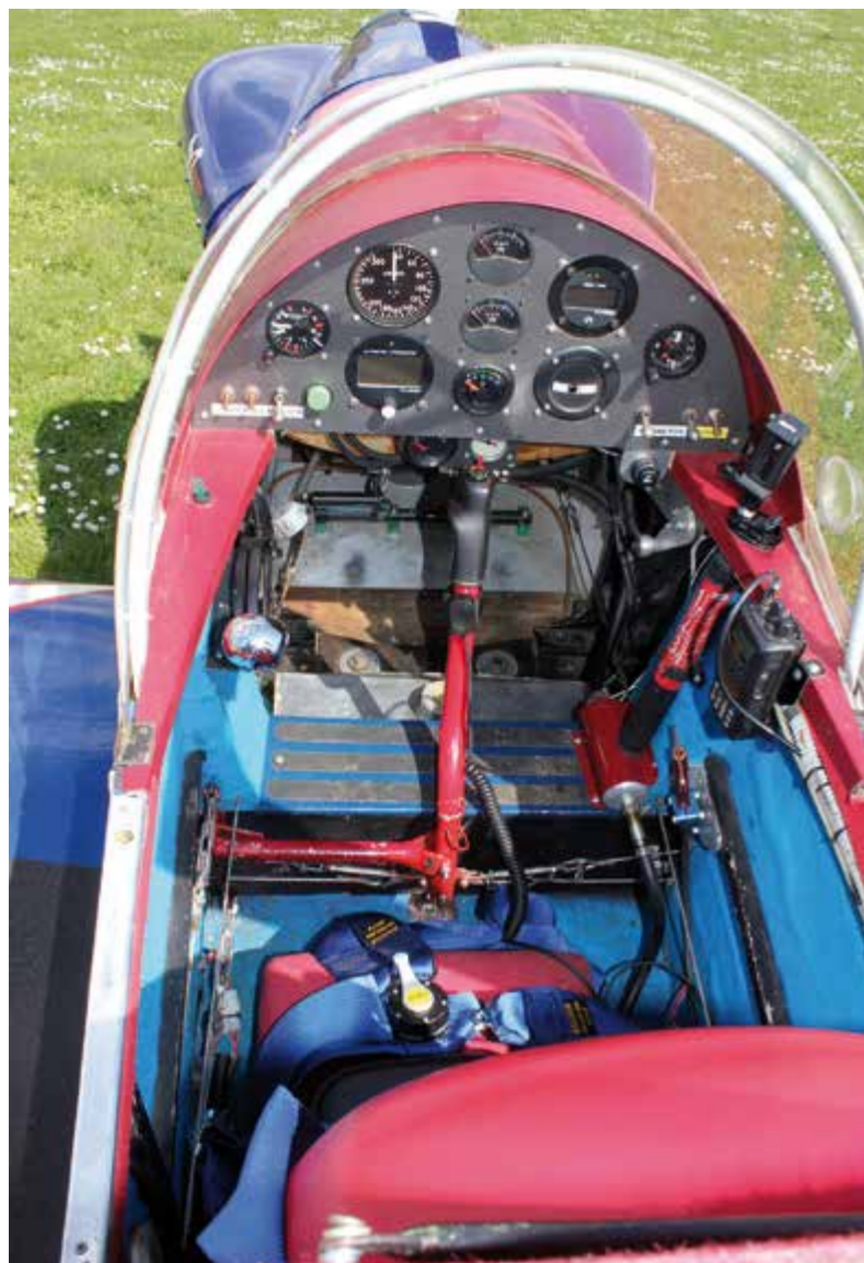
Lo spazio nel cockpit è quello indispensabile e nulla più, le cinture sono a cinque punti, la strumentazione essenziale
