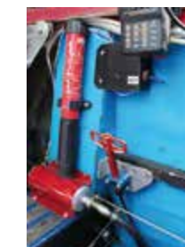
Sulla fiancata destra il comando paracadute, in posizione ottimale, e un estintore manuale
