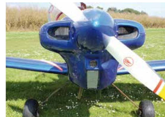
Il radiatore olio è verticale, il flusso che entra dal piccolo foro tondo è sufficiente a raffreddare la coppa olio alettata e il radiatore olio
